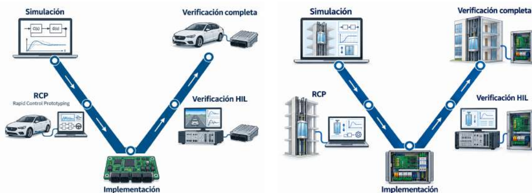
Figura 1. Diagrama en V aplicado al desarrollo de sistemas de control: (A) automoción y (B) ascensor.
