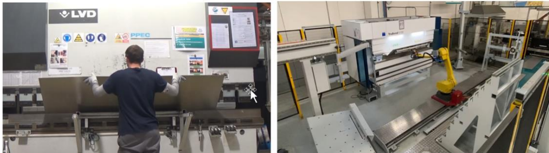
Figura 7. Plegadora manual Vs robotizada
