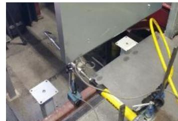
Figura 2. Aplicación de carga y medida de deformación en faldón
