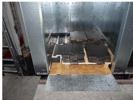
Figura 8. Ensayo de fatiga en cabina y carga descentrada en suelo para ensayo de acuífamiento
