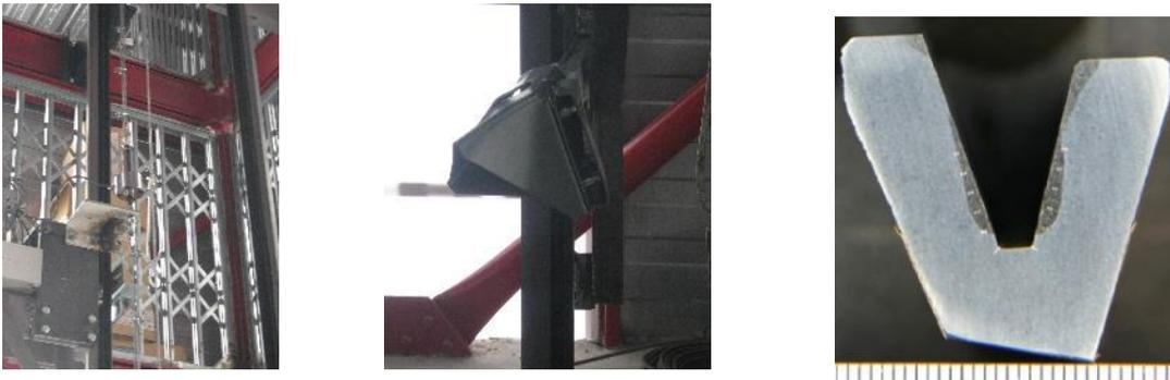
*Figura 5. Instalación para ensayo de limitador, soporte tras ensayo y corte de polea*
