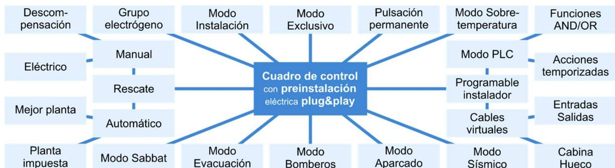
Desde el modo instalación para mover el ascensor con una mínima parte instalada o el clásico modo inspección usado para mantenimiento, el sistema del control del ascensor ofrece diversas opciones para distintas situaciones: Modos que permiten a un usuario autorizado tomar el ascensor para su
